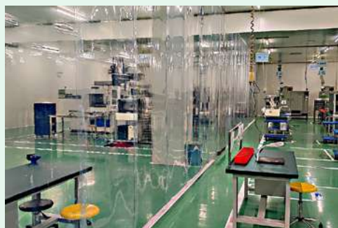
成型作業エリア (左) と後工程エリア (右) に間仕切りを設置し、空調を管理
