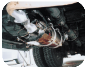
ディーゼル微粒子除去装置（中央丸い筒）はマフラーの隣に取り付けられています
