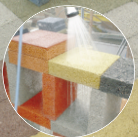
7 高い透水性が特長。透水性舗装材をはじめ側溝蓋、プランター、暗渠など様々なところで使われています
