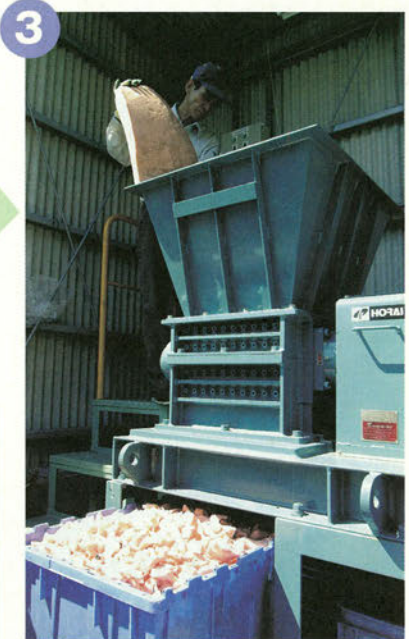
3 大きな材料は破碎機にかけ、10cm角サイズまで碎く。
