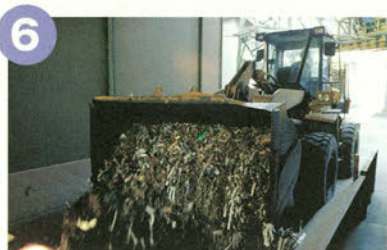
6 トラックのシャベルですくわれ、塊状系投入口と呼ばれる入口から投入。ベルトコンベヤーに乗って、ロータリーキルン内へ。石灰石等の原料とともに燃焼して影も形もなくなる。
