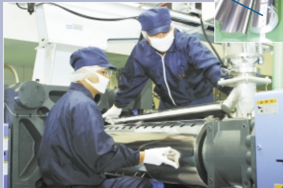
▲射出成形機シリンダーへの断熱保温材取り付け
