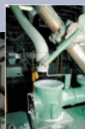
パイプ押出機フィーダーシュート部粉塵（C品）の捕集回収
