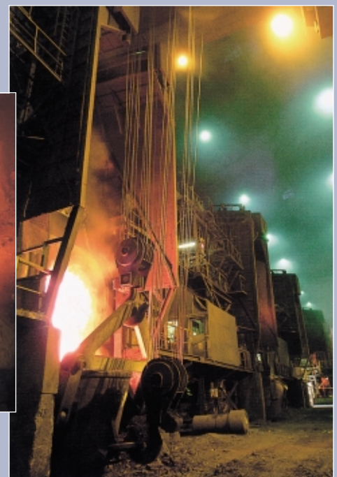
転炉 反射炉で分離した鐵(かわ)から粗銅を分離▶
