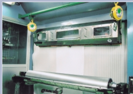
▲オフライン洗浄装置 カセット式のロールを機械から外し、洗浄装置にセット。密閉系洗浄のため洗浄中は蓋をかぶせる
