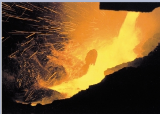
反射炉 微粉炭と重油を燃料にして銅精鉱を溶解し鐵(かわ)と鐵(からみ)に分離。廃プラはこの代替燃料として使用▼
