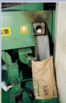
フィルム押出機ベントアップ品（C品）のA品格上げ回収
