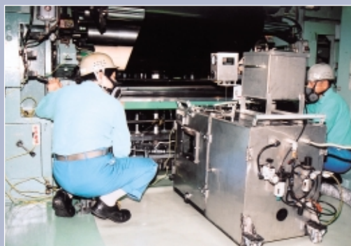
▲配合物供給ユニット コーティング剤をタンクから手作業で塗工パンに供給していたが、ポンプ及びみ上げ自動供給式に変更
