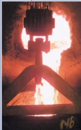
転炉 反射炉で分離した鐵(かわ)から粗銅を分離▶
