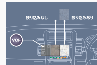
視野範囲/光路制御フィルム 『VCF』 シリコンゴムの遮光層と透明層を 交互に配列したルーバフィルム フロントガラスやドアガラスへの映り 込みを防止
