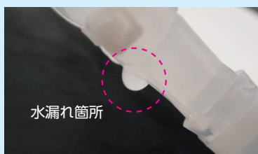
組み立て品における水漏れ発生具合
