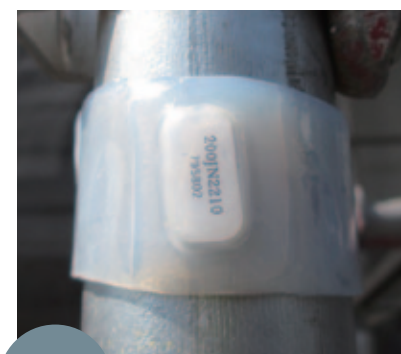
その他 Other 工具等へのRFID固定 RFID fastening to tools, etc.
