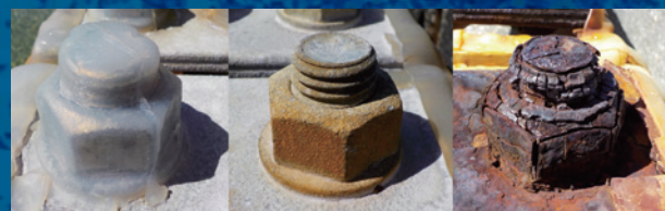
ポリマエース® 被覆 腐食無し 亜鉛メッキ塗装 腐食小 処理なし 腐食大
