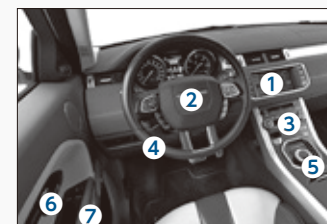
各種車載入力デバイス ① オーディオ・ナビディスプレイ ② ステアリングスイッチ ③ センターコンソールスイッチ ④ エンジンスタートストップスイッチ ⑤ 電子シフタースイッチ 電動パーキングブレーキスイッチ ハブティックスイッチ ⑥ シートメモリースイッチ ⑦ パワーウィンドウスイッチ
